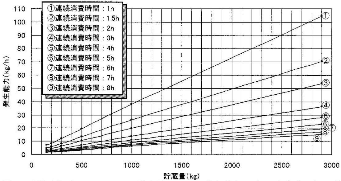
付図3.1 充填時組成  $C_3H_8$  : 95mol%, 残液量 : 15wt%, 地中温度 : 10°C, 充填時温度 : 10°C
