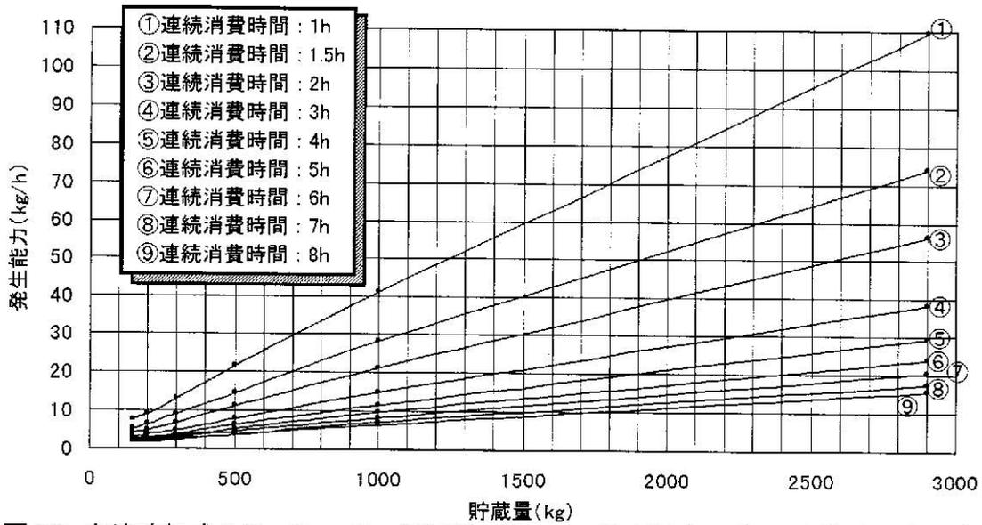
付図3.5 充填時組成  $C_3H_8$  : 95mol%, 残液量 : 20wt%, 地中温度 : 5°C, 充填時温度 : 5°C
