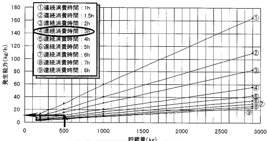
付図3.8 充填時組成  $C_3H_8$  : 95mol%， 残液量 : 30wt%， 地中温度 : 5℃， 充填時温度 : 5℃
