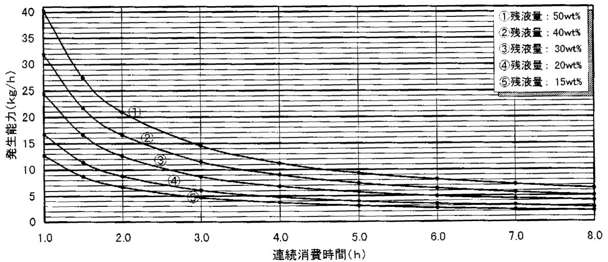
付図 1.12 500kg 縦型, 充填時組成  $C_3H_8$ : 95mol%, 地中温度: 0°C, 充填時温度: 0°C
