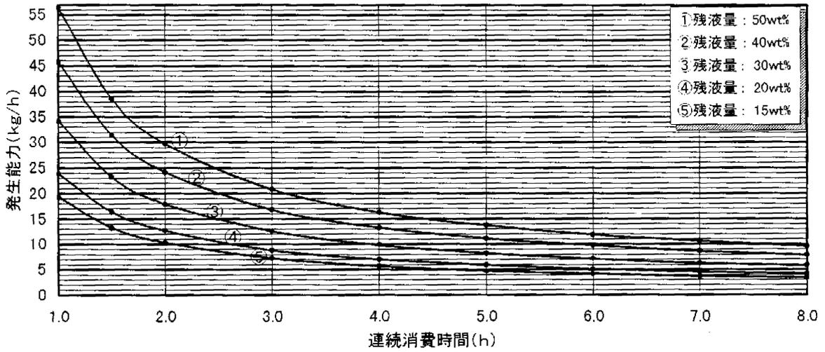
付図 1.10 500kg 縦型, 充填時組成  $C_3H_8$ : 95mol%, 地中温度: 10°C, 充填時温度: 10°C
