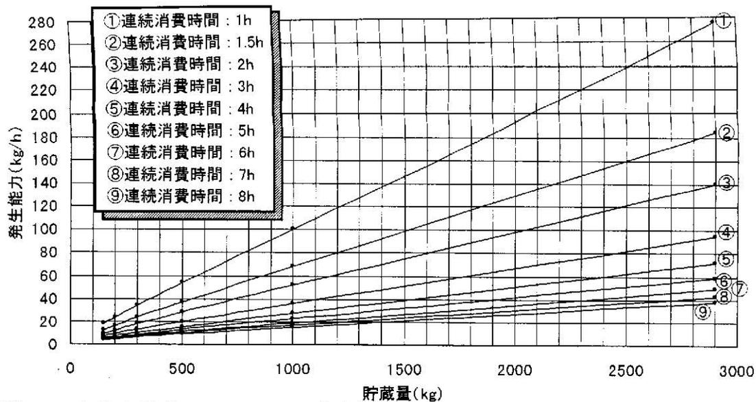
付図4.13 充填時組成  $C_3H_8$  : 90mol%, 残液量 : 50wt%, 地中温度 : 10°C, 充填時温度 : 10°C
