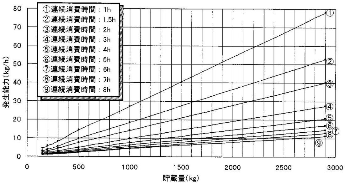
付図4.2 充填時組成  $C_3H_8$  : 90mol%, 残液量 : 15wt%, 地中温度 : 5°C, 充填時温度 : 5°C
