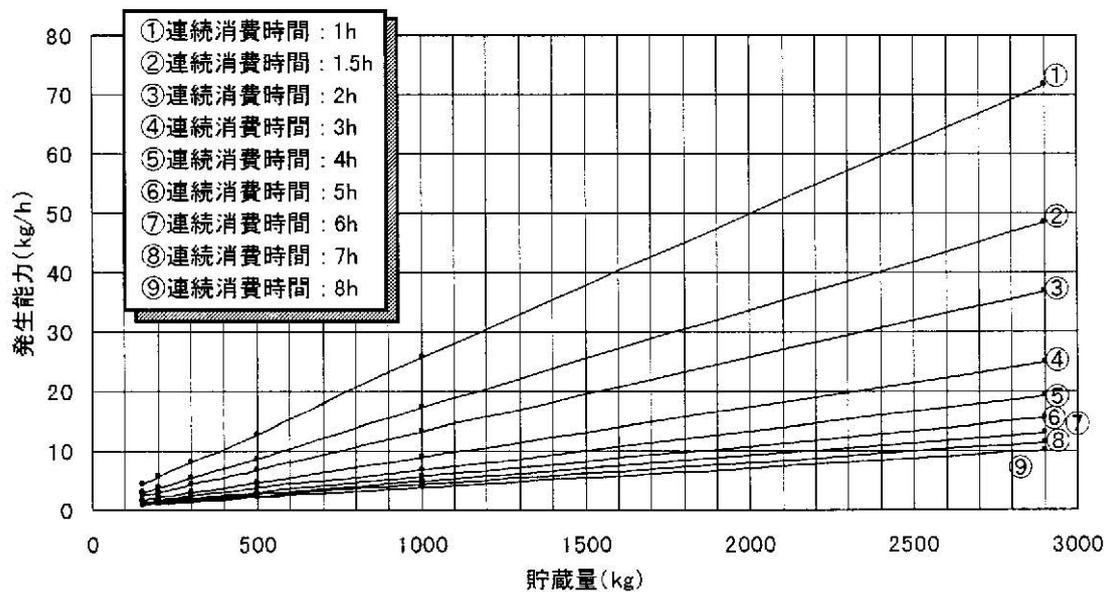
付図3.3 充填時組成  $C_3H_8$  : 95mol%, 残液量 : 15wt%, 地中温度 : 0°C, 充填時温度 : 0°C
