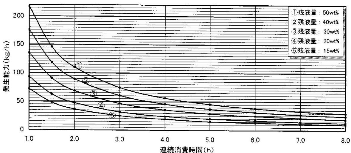
付図 1.18 2.9t 縦型, 充填時組成  $C_3H_8$  : 95mol%, 地中温度 : 0°C, 充填時温度 : 0°C
