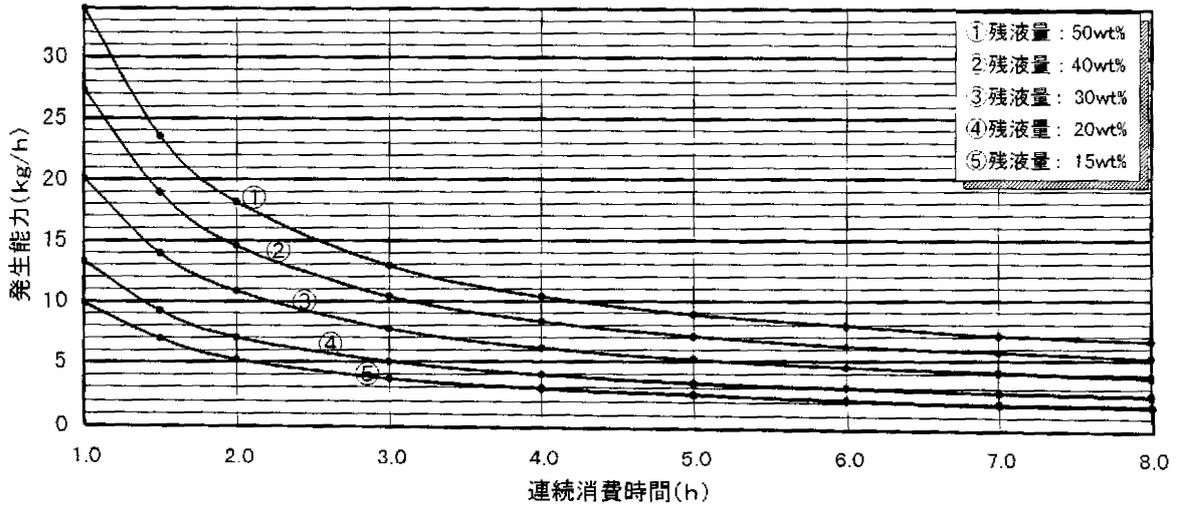
付図 2.7 300kg 縦型, 充填時組成  $C_3H_8$  : 90mol%, 地中温度 : 10°C, 充填時温度 : 10°C
