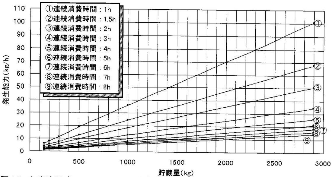
付図4.5 充填時組成  $C_3H_8$  : 90mol%, 残液量 : 20wt%, 地中温度 : 5°C, 充填時温度 : 5°C
