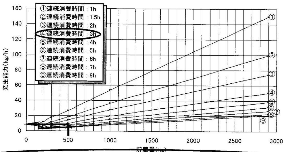
付図4.8 充填時組成 C<sub>3</sub>H<sub>8</sub>：90mol%， 残液量：30wt%， 地中温度：5℃， 充填時温度：5℃
