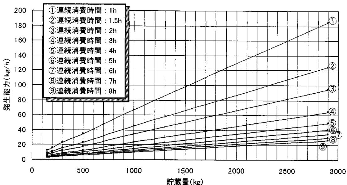
付図3.7 充填時組成  $C_3H_8$  : 95mol%, 残液量 : 30wt%, 地中温度 : 10°C, 充填時温度 : 10°C
