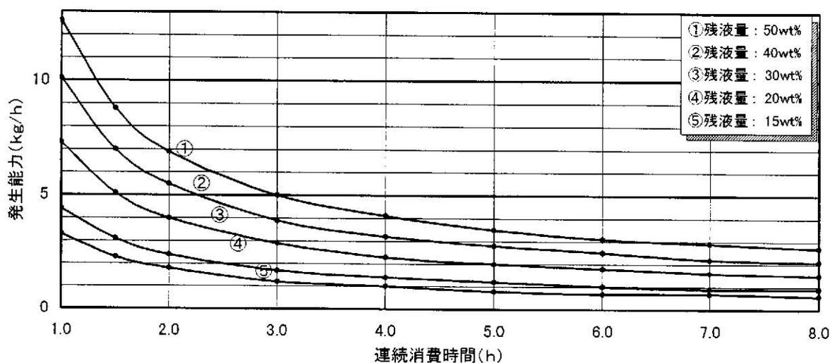
付図 2.3 150kg 縦型, 充填時組成  $C_3H_8$  : 90mol%, 地中温度 : 0°C, 充填時温度 : 0°C
