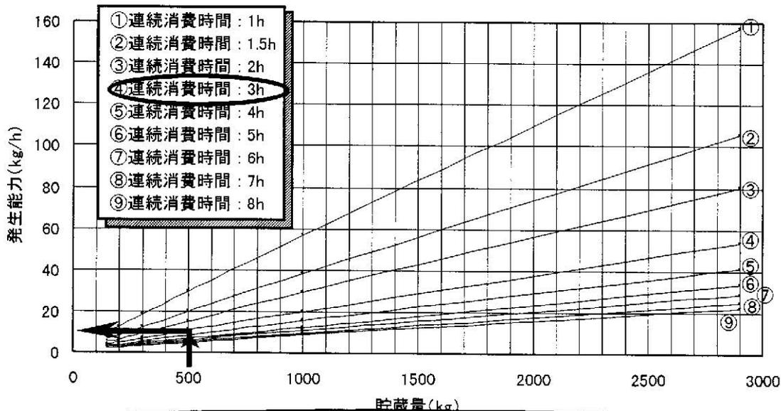
付図5.2 充填時組成 C<sub>3</sub>H<sub>8</sub> : 95mol%， 残液量 : 30wt%， 地中温度 : 5°C， 充填時温度 : 5°C
