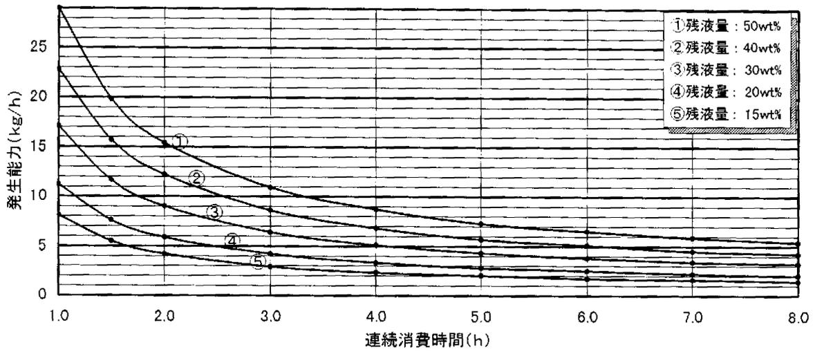
付図 2.8 300kg 縦型, 充填時組成  $C_3H_8$  : 90mol%, 地中温度 : 5°C, 充填時温度 : 5°C
