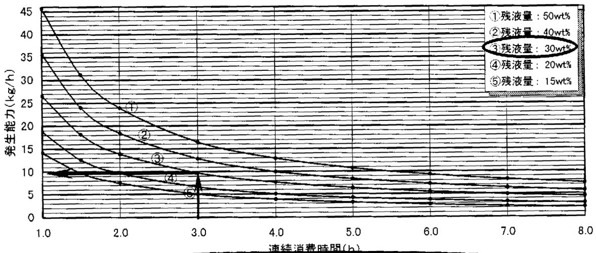
付図2.11 500kg縦型，充填時組成C<sub>3</sub>H<sub>8</sub>：90mol%，地中温度：5°C，充填時温度：5°C
