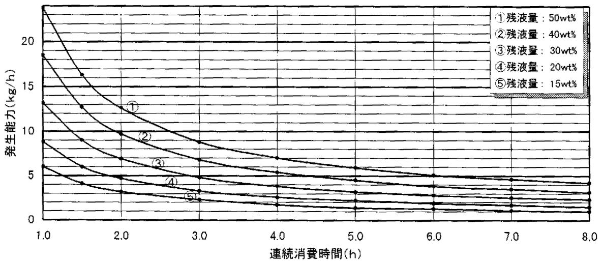
付図 2.9 300kg 縦型, 充填時組成  $C_3H_8$  : 90mol%, 地中温度 : 0°C, 充填時温度 : 0°C
