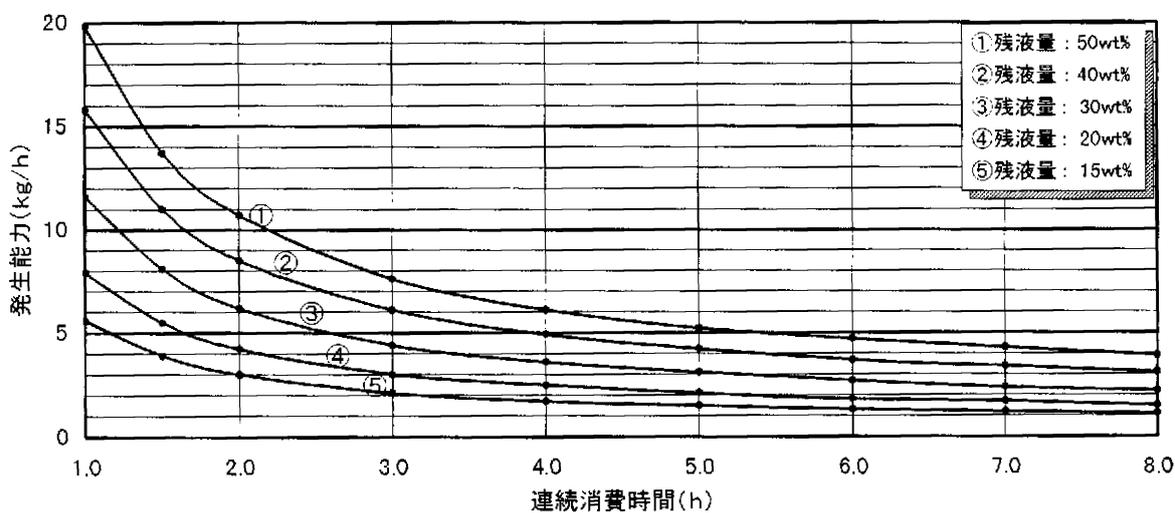
付図 2.5 200kg 縦型, 充填時組成  $C_3H_8$  : 90mol%, 地中温度 : 5°C, 充填時温度 : 5°C
