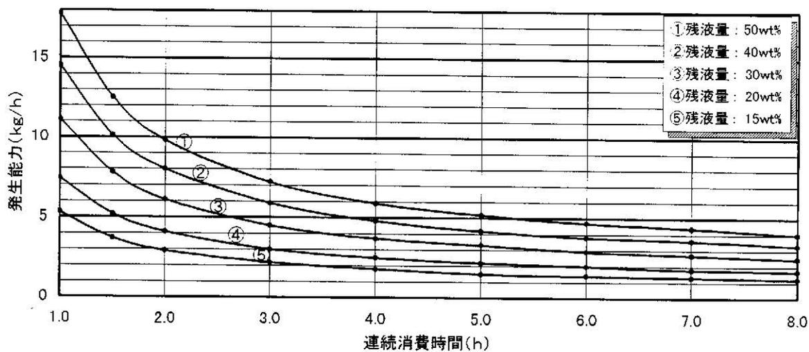
付図 2.1 150kg 縦型, 充填時組成  $C_3H_8$  : 90mol%, 地中温度 : 10°C, 充填時温度 : 10°C
