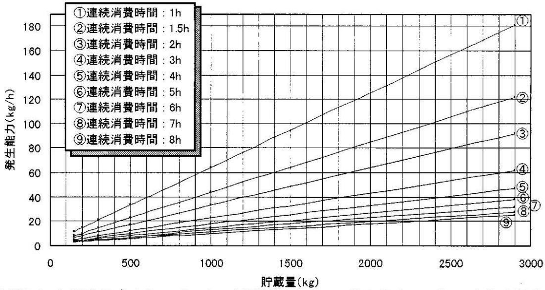
付図 5.1 充填時組成  $C_3H_8$  : 95mol%, 残液量 : 30wt%, 地中温度 : 10°C, 充填時温度 : 10°C
