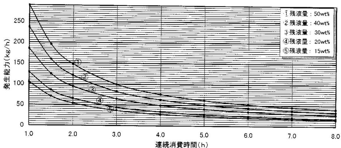
付図 1.16 2.9t 縦型, 充填時組成  $C_3H_8$  : 95mol%, 地中温度 : 10°C, 充填時温度 : 10°C
