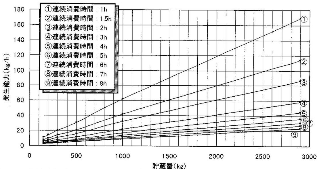
付図 4.7 充填時組成  $C_3H_8$  : 90mol%, 残液量 : 30wt%, 地中温度 : 10°C, 充填時温度 : 10°C
