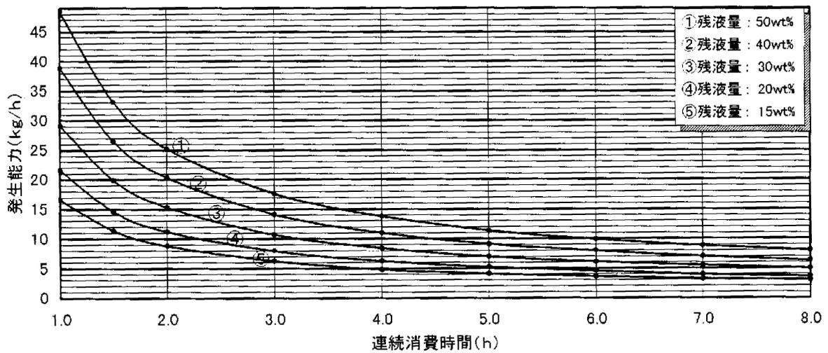
付図 1.11 500kg 縦型, 充填時組成  $C_3H_8$ : 95mol%, 地中温度: 5°C, 充填時温度: 5°C
